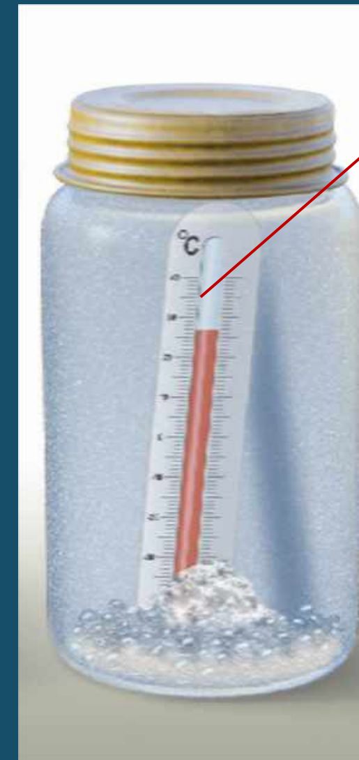
Termometro in barattolo chiuso con tre cucchiari di aceto e uno di bicarbonato
