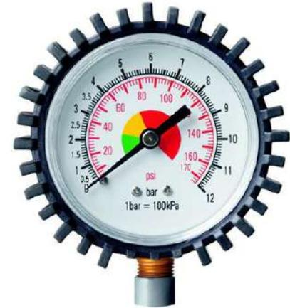
Il manometro della pompa usata per gonfiare gli pneumatici misura spesso la pressione in bar.
