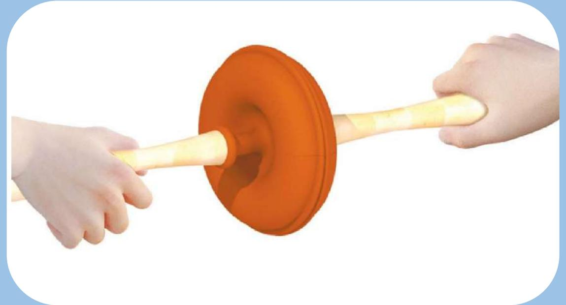
La forza da vincere per separare le cupole e le ventose è dovuta alla **pressione atmosferica**: quando all'interno viene creato il vuoto, la pressione atmosferica agisce solo sulla superficie esterna.
