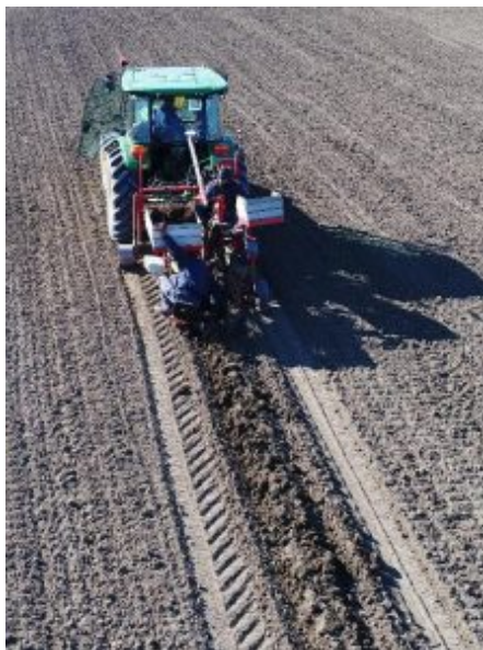
9. Trapianto meccanico con guida GPS.
